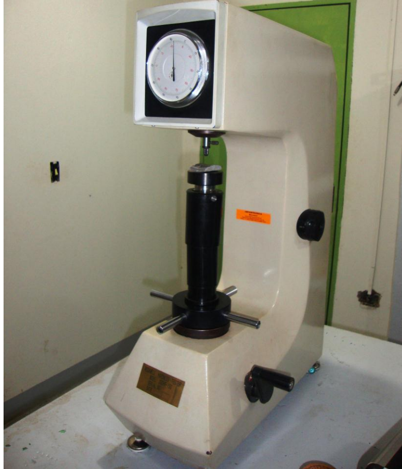
FIGURA 14 – Fotografia do equipamento utilizado para medir as durezas vista diagonal
